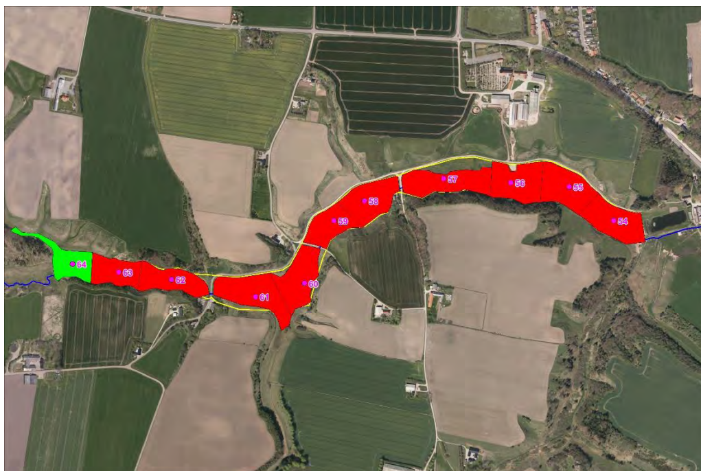
Figur 2.9.4. Screening af risikoen for P-frigivelse i det sydlige undersøgelsesområde fra de enkelte prøvetegningsfelter baseret på molforholdet mellem Fe og P (se også teksten for forklaring). Grønt indikerer et Fe:P-molforhold på >20, gul indikerer et Fe:P-molforhold mellem 10 og 20 og rød indikerer et Fe:P-molforhold under 10.
